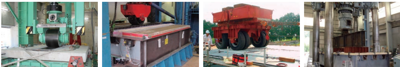
日本大学生産工学部(RC床版)輪荷重走行試験
