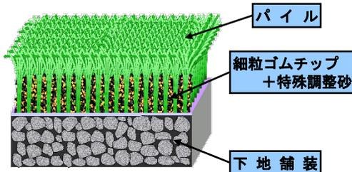
パイル長が50~75mm内外と長く、パイル（葉茎）の隙間に特殊な砂およびゴムチップを充填した透水性の人工芝です。
