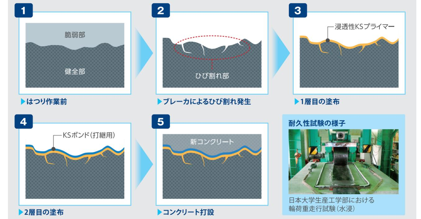
道路橋コンクリート床版は、輪荷重の繰り返し载荷を直接受ける部材であり、疲労による変状が生じます。積雪寒冷地においては、この疲労に加えて、さらに塩害や凍結融解など複合的な劣化による変状が発生しており、このような変状に対する補修・補強は床版上面からの対策が有効です。従来、劣化したコンクリート上面の撤去には、切削機や人力ブレーカーが用いられていますが、健全なコンクリート部分にも新たに微細ひび割れなどの脆弱部が生じ、脆弱部を起点とした再劣化が生じる場合があります。
