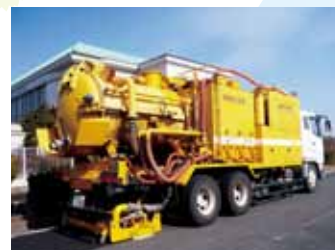
道路高圧除染車
